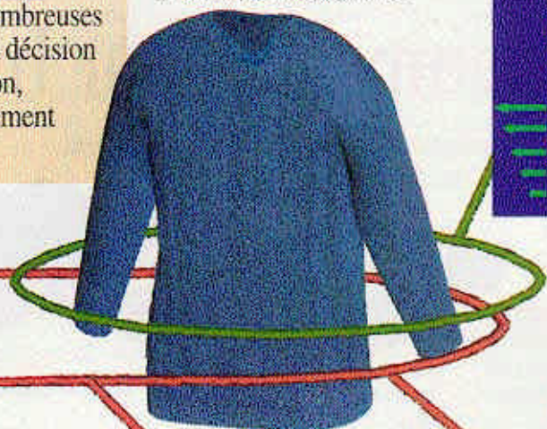
● Modélisée en 3D, la boucle donne une représentation réaliste du liage, à l'endroit comme à l'envers. De plus, ses déformations commencent à être correctement simulées.
